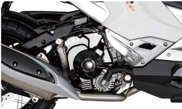
26.5kW (36.7hp) を発揮する、パワフルな399cc単気筒エンジンを搭載。荒れた路面でも確実に駆動力を伝える、トラクションコントロールシステムも装備しています。
