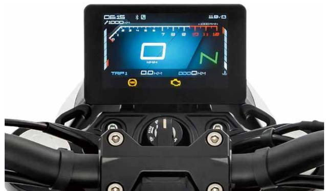
フルカラー TFT液晶を採用。速度、距離、ガソリン量、時刻、外気温を表示します。スマートフォンとのコネクト機能を持ち、さまざまな情報を表示できます。
