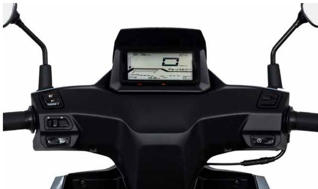
速度、距離、ガソリン量、時刻、外気温を表示。車体同様にスタイリッシュなデザインの液晶表示で、走行中も情報が見やすくなっています。メーター上部にはバイザーを装備し、高速走行時の整流効果を高めています。
